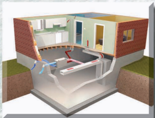
Un système de ventilation continue et équilibrée apporte de l'air frais à l'intérieur tout en évacuant l'air vicié.
